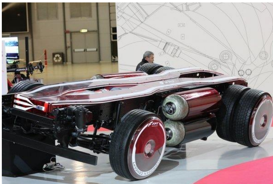
Figura 9: Prototipo di sistema di propulsione a celle a combustibile a idrogeno sviluppato da FPT Industrial
